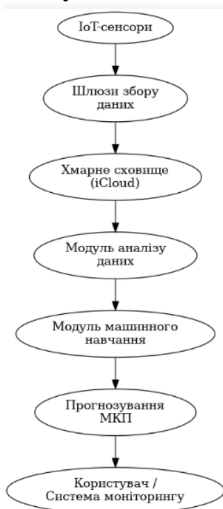
Рисунок 1 – Архітектура хмарної системи комплексного опрацювання вимірювальної інформації
